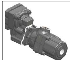
2 - Die Pumpe 10 mm vom Nebenantrieb entfernen..
