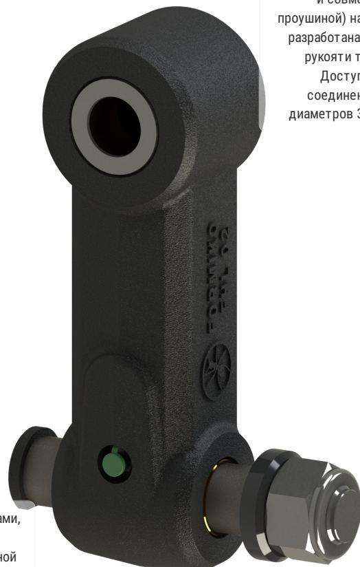
Подвеска FHL 02 верхняя часть выполнена в виде одиночной проушины и совместима с вилкой (двойной проушиной) на рукояти крана. Подвеска разработана для кранов с окончанием рукояти типа вилка шириной 80мм. Доступны модели подвески для соединения с пальцами различных диаметров 30мм, 35мм, 40мм, 45мм, .
